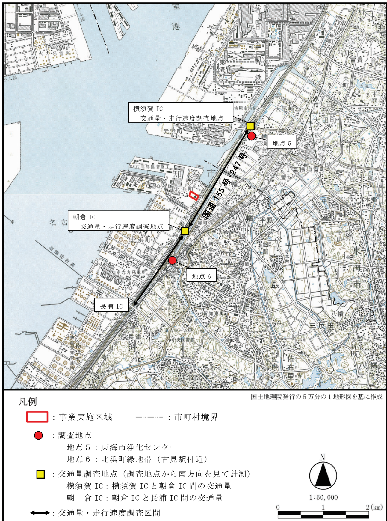
図 8.2.1(2) 道路交通騒音の現地調査地点
