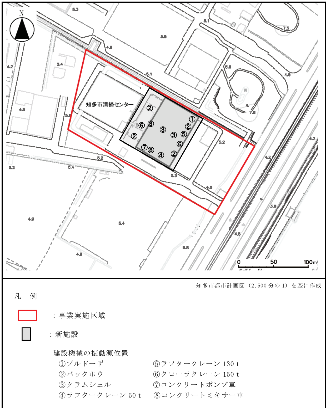
図 8.4.6 建設機械の配置（複合機械による影響）
